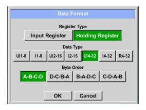
Selection Register Type Holding Register, Data Type *U1(32b)* und Byte Order *A-B-C-D* **HWord** LWord HByte LByte HByte LByte 29235175522 => ΑE 41 56 Data Order 1.Byte 2.Byte 3.byte 4.Byte 56 A-B-C-D ΑE 41 52 D-C-B-A 52 56 41 ΑE B-A-D-C 41 ΑE 52 56 C-D-A-B 56 52 ΑE 41
